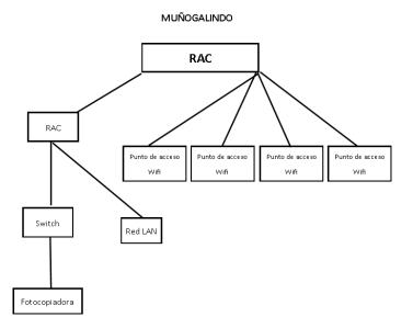
La Serrada: Desde el RAC de escuelas conectadas sale la conexión para los dos puntos de acceso Wifi (uno en cada aula) y la conexión a un antiguo router de Movistar que hemos transformado en switch para dar conexión a la fotocopiadora.
