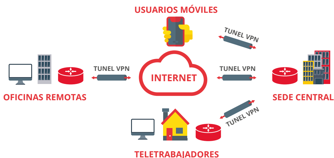
Ilustración 1 Estructura de una VPN para una empresa
