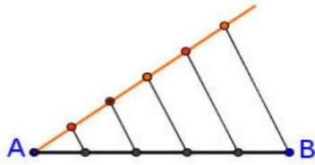
Trazamos una semirrecta a partir de A. Sobre ella marcamos, con el compás, 5 segmentos iguales, de la longitud que queramos. Unimos la última marca con B y trazamos paralelas, una por cada marca de la semirrecta
