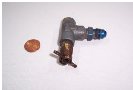
Purgador hidráulico manual
