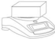
Mantenga la balanza limpia. No amontone material sobre la balanza/báscula cuando no está en el uso. La Highland tiene una característica para amontonar más de una unidad encima de otra que no le aplica peso al plato. Para obtener más detalles véase la sección de almacenar.
