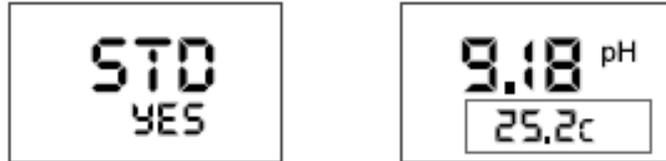
Caso de utilizar una solución tampón diferente ajuste, mediante el botón SLOPE (▲/▼) (2.3), el valor del pH en pantalla al valor de pH de la solución a la temperatura de trabajo.
