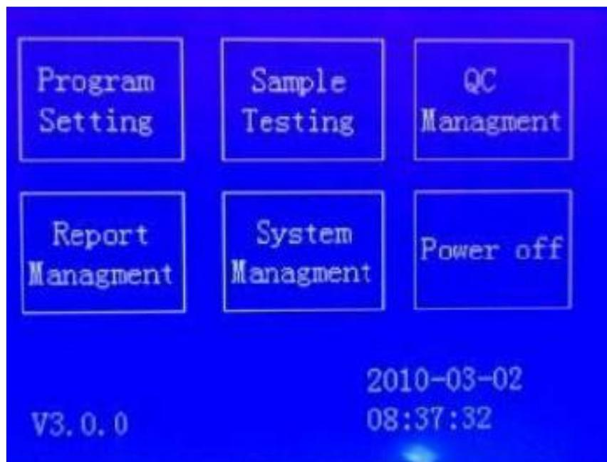
En esta pantalla se selecciona el procedimiento a realizar. Los más frecuentes son la configuración del programa (*Program setting*) y el análisis de muestras (*Sample testing*).
