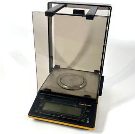
La balanza tiene una capacidad máxima de 120 gramos y una resolución de 0,001 gramos.
