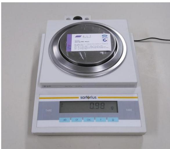
La balanza tiene una capacidad máxima de 610 gramos y una resolución de 0,1 miligramos, lo que significa que puede medir la masa de muestras con una precisión de 0,0001 gramos.
