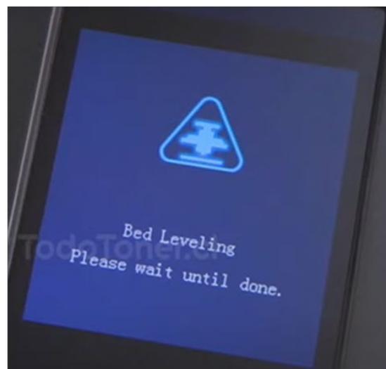
12º) Ajustar eje Z para mantener la distancia entre la boquilla y la plataforma del grosor de una hoja de papel A4 ( $0,8\text{mm} - 1\text{mm}$ )
