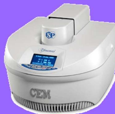
Aparato diseñado para síntesis con MW.
