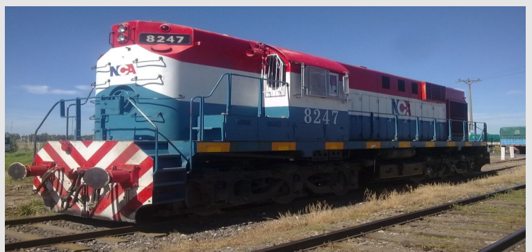
La RSD-16 aparece en el Catalogo ALCO de 1956, como modelo de exportación. Es una locomotora de operación bidireccional, con la cabina desplazada hacia una de las trompas. Está clasificada como apta para servicios de carga, de pasajeros y maniobras.
