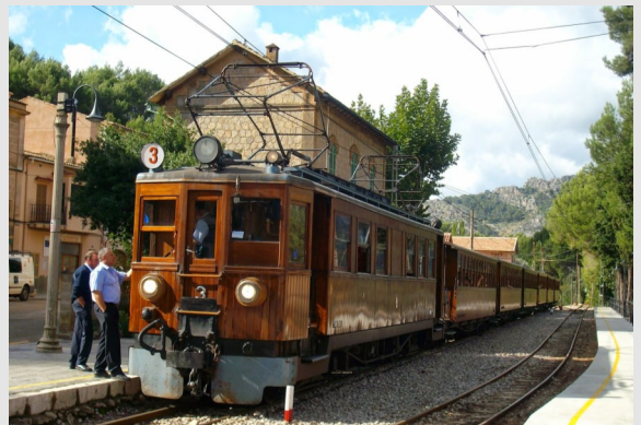
Ten turístico de Soller con locomotora eléctrica de corriente continua de 1.200 V.
