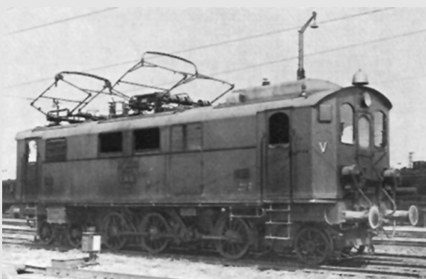
Locomotora alemana EP 3/6 20.102 para trenes de pasajeros de la región alemana de Baviera. Gracias a sus buenas condiciones técnicas, no fue apartada de servicio hasta 1941, después de más de 25 años de uso. Tras la desafectación, fue transformada en máquina quitanieves.
