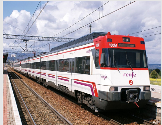
Locomotora de la serie 446 de RENFE para trenes de cercanías, de 2.400 kW de potencia que permiten una aceleración de 1 \text{ m/s}^2 al arrancar pero su velocidad máxima es de 100 km/h.
