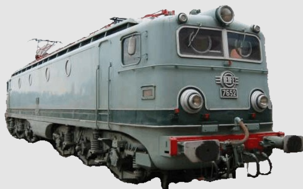
Locomotora eléctrica fabricada por la empresa francesa Alstom para Renfe de la serie 7600 de la década de 1950 y que podría alcanzar la
