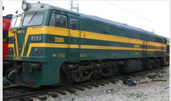
Locomotora 2180, que tiene 2.180 CV de potencia, y alcanzaba una velocidad de 120 km/h. Pertenece a la serie 321 de locomotoras que se construyeron entre 1965 y 1970.
