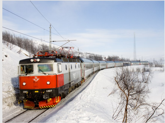
Locomotora sueca Rc fue la primera en usar tiristores con motores CC.
