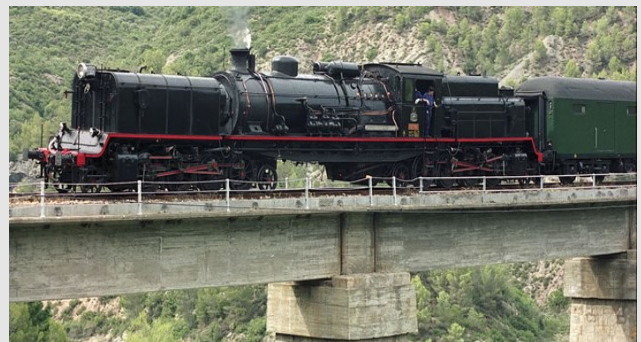
Locomotora de vapor del tipo Beyer-Garratt (nombre que responde a la unión entre el apellido del inventor del sistema, Herbert William Garratt, y el nombre de la fábrica constructora de locomotoras Beyer Peacock).
