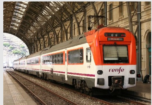
Locomotora de la serie 448 para servicio de los trenes Intercity, que alcanzaban una velocidad máxima de 160 km/h.
