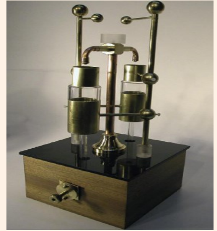
Réplica de un diseño de 1907 de un generador electrostático de Lord Kelvin.
