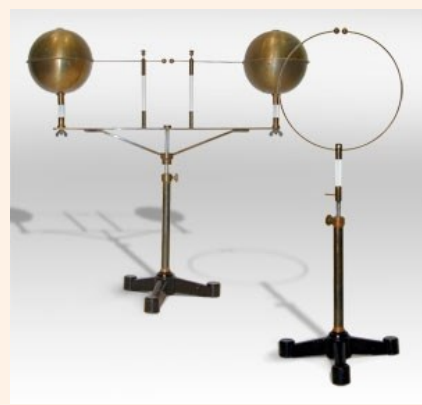
Instrumental con el que Hertz logró demostrar la teoría de Maxwell.
