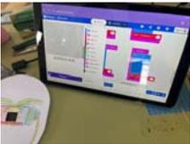
Una vez acabada la programación, hemos pegado con celo la placa MicroBit a la cara y hemos podido comprobar cómo va cambiando su expresión dependiendo de lo que hagamos: agitarlo, ponerlo cabeza abajo, tumbarlo boca arriba o boca abajo o realizar un sonido fuerte.
