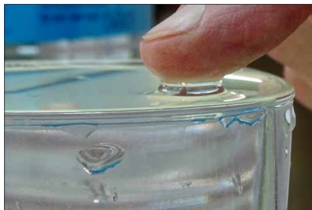
Figura 22. Formación de una columna de líquido tras mojar la yema del dedo.
