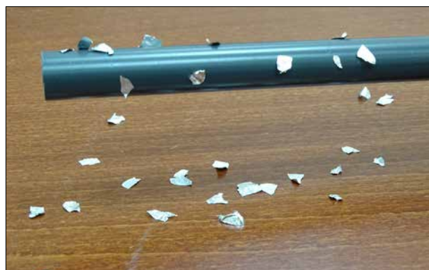
Figura 38. La barra de PVC electrificada atrae pequeños trozos de papel de aluminio y luego los repele.
