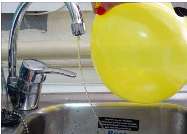
Figura 35. Un globo electrizado atrae a un fino chorro de agua.
