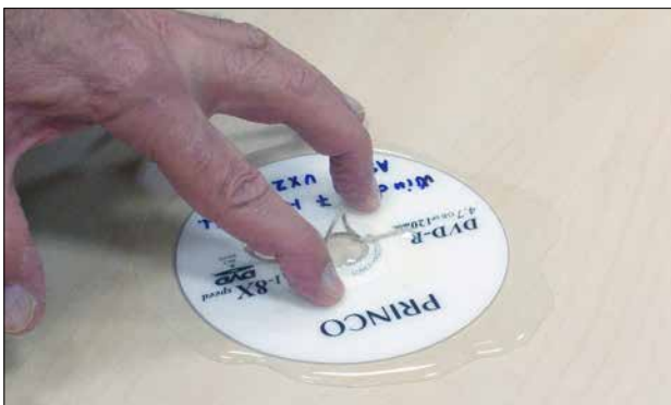
Figura 27. Fuerzas de adhesión entre el agua y el CD y entre el agua y la mesa.
