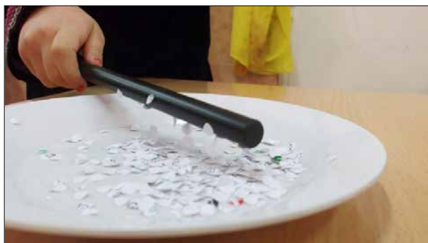
Figura 36. Atracción de pequeños trozos de papel por una barra de PVC frotada con una servilleta de papel.
