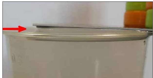
Figura 25. Adherencia entre el líquido (agua) y el plástico de la tarjeta.
