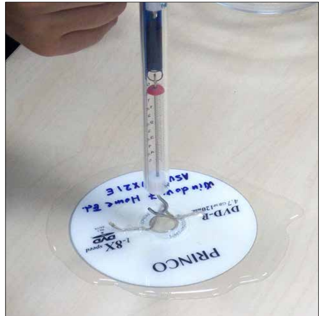
Figura 28. Midiendo las fuerzas de adhesión con un dinamómetro.
