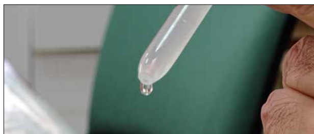
Figura 12. Formación de una gota: observamos las fuerzas de adherencia y cohesión.
