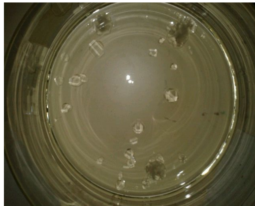
Fig 3. Proceso de cristalización de KDP por el método de evaporación lenta del disolvente.
