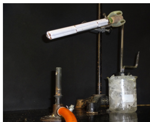
Fig.2: Esquema del montaje de la destilación
