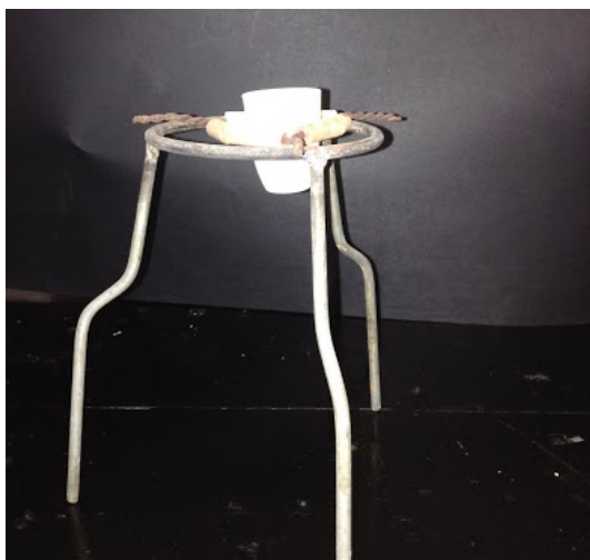
Fig.4: Crisol sujeto en un Triángulo de Terracota y soporte
