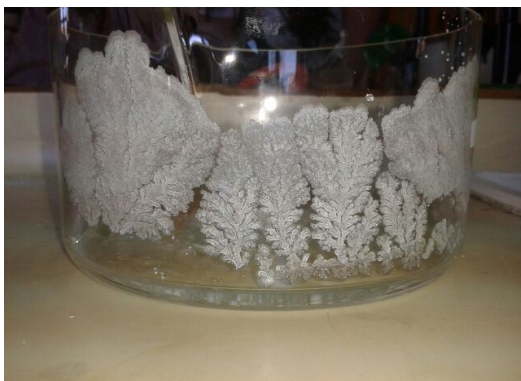
Fig 4. Estructura cristalina de \text{NaCl} en forma de dendritas.
