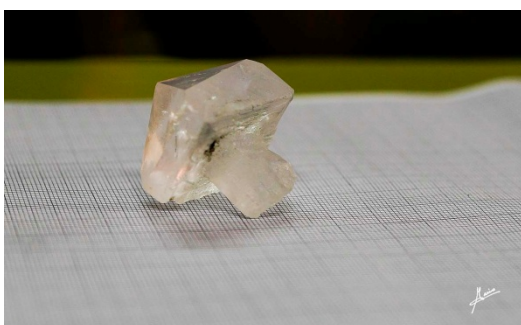
Fig 8. Cristal de KDP crecido por la técnica de descenso de la temperatura de la disolución.
